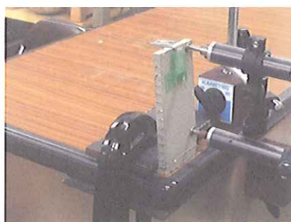
写真3 変位量の測定の様子
