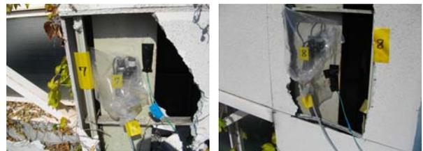
写真 9 加速度センサー・ひずみゲージ設置状況
