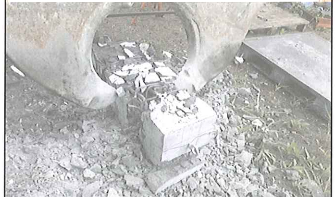
W/C13模擬梁において 一挙に圧砕が進んだ状況
