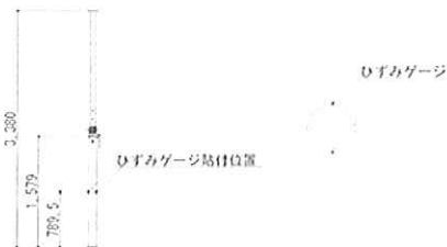
図 3 サポートのひずみゲージ貼付位置
