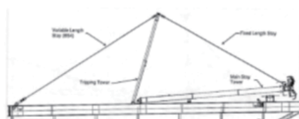
仮設タワー設置用のトリッピングタワー
