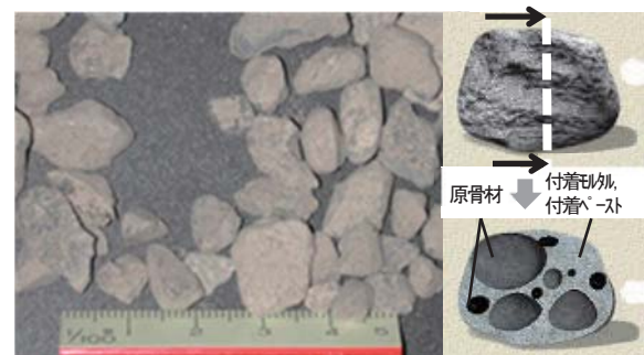
図1 再生骨材の外観と断面のイメージ 7)
