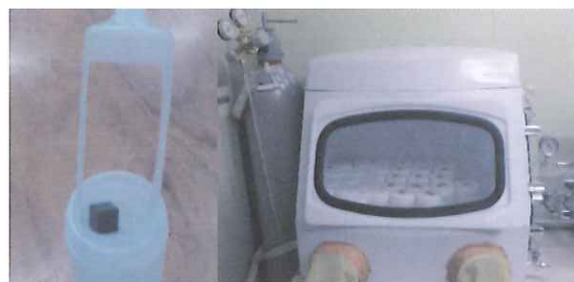
試料と浸漬容器 保管状況(グローブボックス内)
