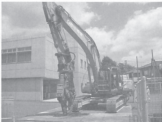
写真8 現在の圧砕アタッチメントと重機
