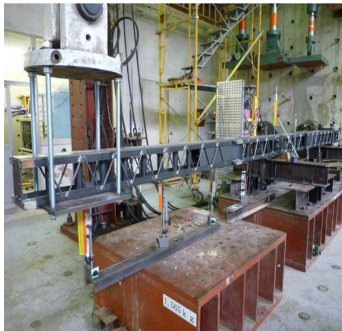
連結部材強度試験（於：筑波大学）
