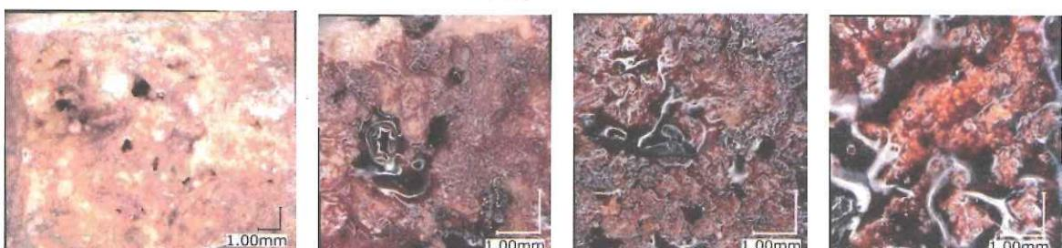
(a) 含浸 1 回目 (b) 含浸 2 回目 (c) 含浸 3 回目 (d) 含浸 4 回目
