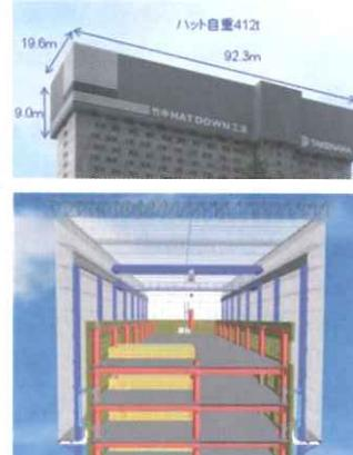
図-3 竹中ハットダウン工法
