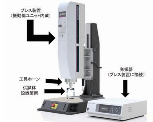
図-1 超音波溶着機の装置概観
